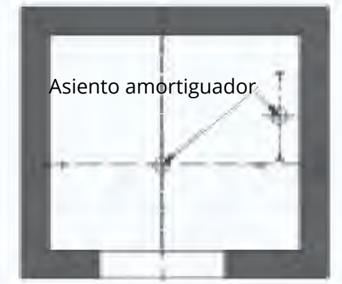
Vista en sección del hueco del ascensor
